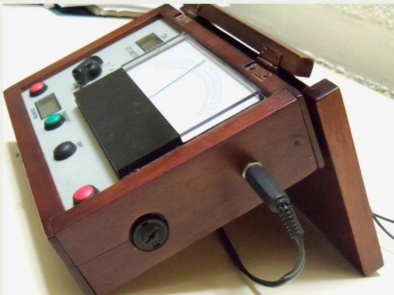
Coloca las latas sobre la mesa de manera que no se toquen y notarás que la aguja se mueve de inmediato hacia la izquierda. Y el "TA" marcará 2. Si tocas una lata con la otra, la aguja se moverá con fuerza hacia la derecha porque prácticamente no hay resistencia, ya que las latas y el cable son muy buenos conductores. No dejes que las latas sigan en contacto más de unos cuantos segundos; si lo haces, el Mac-Meter podría dañarse.
